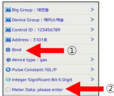
⑦ 주소까지 입력 후 송신기와 수신리시버는 10cm 이내로 근접시켜 Bind 한 뒤 Meter Data 클릭
